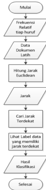
Gambar 5 Flowchart Perhitungan Jarak Euclidean Dan Klasifikasi
