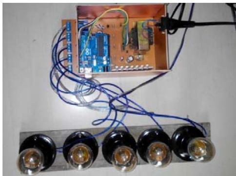
Gambar 9 Ilustrasi Kondisi Sewaktu Pengujian Semua Relay Off
