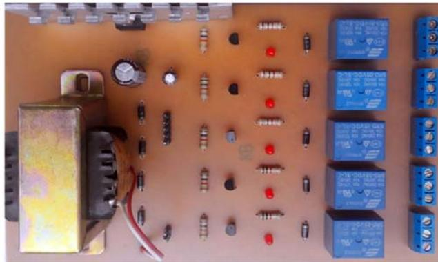
Gambar 5 Rangkaian Relay dan Catu Daya Tampak Atas
