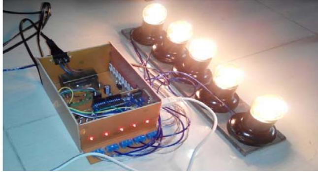
Gambar 10 Ilustrasi Kondisi Sewaktu Pengujian Semua Relay On
