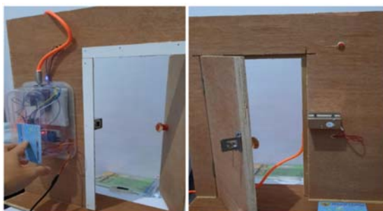
Gambar 11. Prototipe Miniatur Akses Pintu Bagian Depan Dan Belakang
