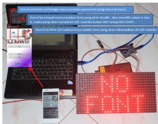
Gambar 16 Tampilan Tulisan Berkedip LED Matriks Jika Kode Font Salah
