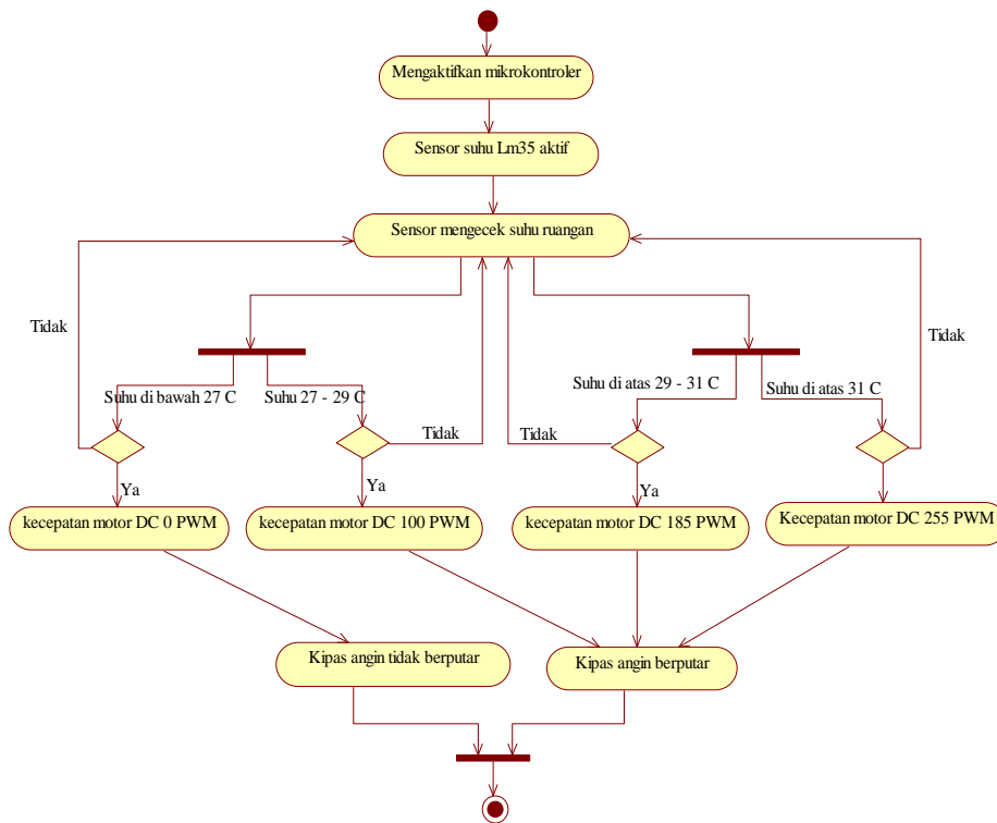
Gambar 3. Diagram Aktivitas Kipas Angin Otomatis Menggunakan Sensor Suhu LM35
